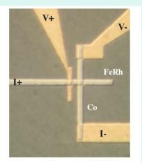
Co/FeRhスピン注入構造
